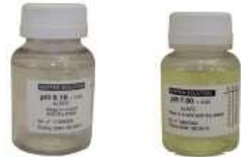
Das Justieren der Messeinrichtung beginnt durch Drücken der Taste √. Auf dem Display des pHoenix Gerätes erscheint der Hinweis **Kal. pH7:x.x?**, wodurch die Bereitschaft angezeigt wird, dass die Sonde in die pH-7 Referenzlösung eingetaucht werden kann. Sobald sich ein stabiler pH- Messwert einstellt, wird die Taste √ gedrückt.
